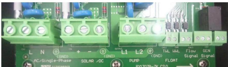
Medidor de flujo y contacto seco del generador (Ofrecemos dial o perilla opcional)
