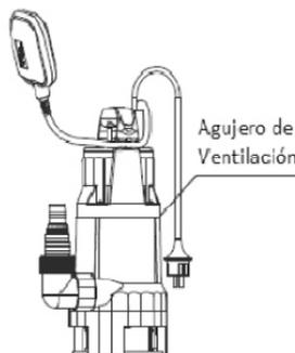
**Remarque:** La position du trou de sortie peut être différente selon les modèles. Les câbles d'alimentation principale ne doivent pas avoir une section inférieure à celle des câbles à gaine en caoutchouc portant la désignation H05RN-F et la désignation H07RN-F.
