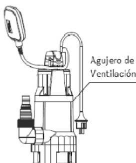
**Nota:** La posición del orificio de salida puede ser diferente según que modelos. Los cables de alimentación principales no deben tener una sección más pequeña que los cables con revestimiento de goma con la designación H05RN-F y la designación H07RN-F.
