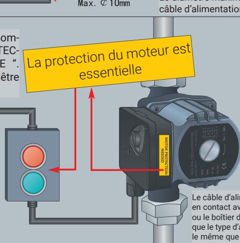
Le câble d'alimentation ne doit pas être en contact avec la tuyauterie, la pompe ou le boîtier du moteur. Et assurez-vous que le type d'alimentation électrique est le même que celui requis sur l'étiquette de la pompe.
