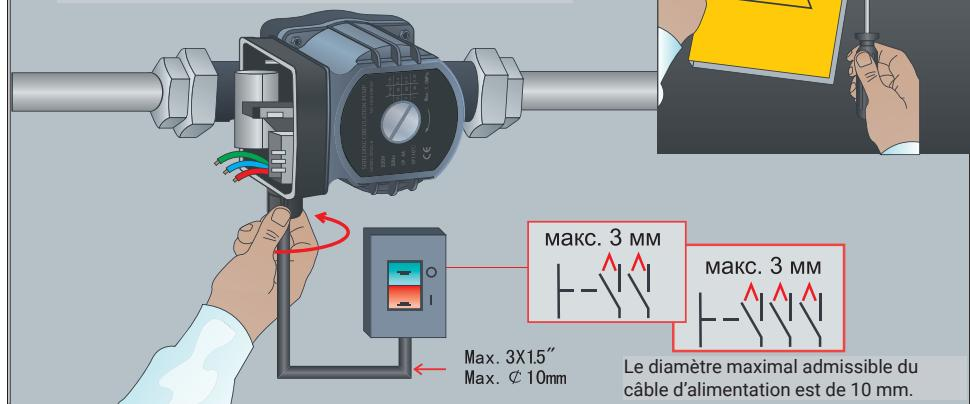
Si la boîte de jonction de la pompe porte la mention "PROTECTION DU MOTEUR REQUISE". Un dispositif de circuit doit être installé.
