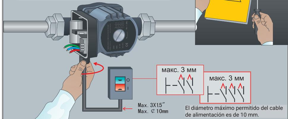
Si hay "PROTECCIÓN DEL MOTOR NECESARIA" marcada en la caja de conexiones de la bomba. El dispositivo del circuito debe estar instalado.
