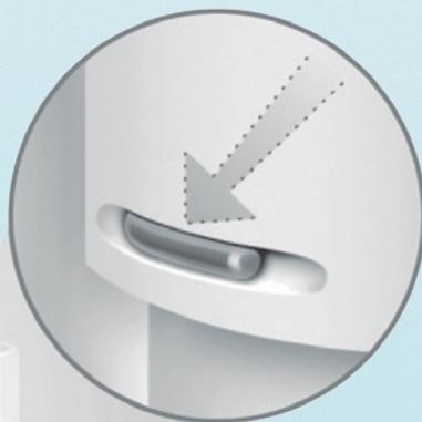
La tubería PYD en uPVC tiene un mecanismo de bloqueo único, el sistema *wirelock*, en el que un alambre de acero inoxidable se enrolla entre el acoplador y el tubo, para asegurar el sistema de tuberías y el rácor y evitar que ambos se suelten accidentalmente. Este sistema *wirelock* es una tecnología patentada.
