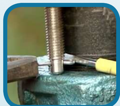
Detalle del pasador en el tirante del guardamotor.
