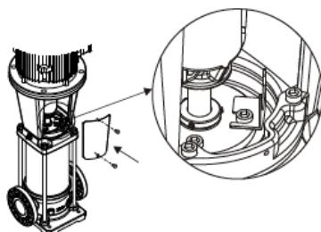
1. Retirez la plaque de réglage, placez-la dans la position indiquée par le diagramme.
