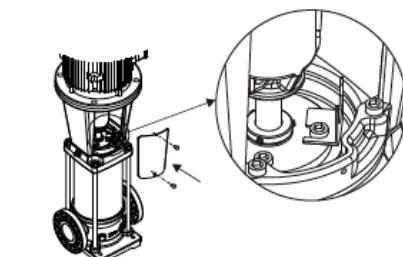
1. Saque la placa de ajuste, póngala en la posición como indica el diagrama.
