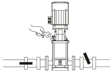
6. Ajuste la presión de la válvula de salida que usted necesita.
