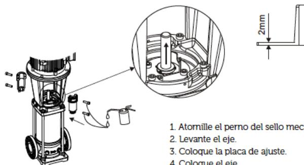
La correcta instalación de acoplamiento.
