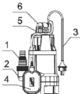
La longueur du câble entre l'interrupteur de niveau (4) et le verrou de l'interrupteur de niveau (5) doit toujours être d'au moins 10 cm. Plus la longueur entre l'interrupteur de niveau (4) et le verrou de l'interrupteur de niveau (5) est courte, plus la hauteur de coupure est faible à l'intérieur et plus la hauteur de coupure est élevée à l'extérieur.
