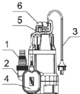
El cable de longitud entre el interruptor de nivel (4) y el interruptor de bloqueo de nivel (5) deberá estar siempre al menos a 10 cm. Cuanto más corta sea la longitud entre el interruptor de nivel (4) y la cerradura del interruptor de nivel (5), menor será la altura de corte dentro y mayor será la altura de corte fuera.
