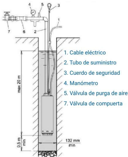
La bomba puede mantenerse en una posición suspendida por la tubería de suministro de metal. Apriete firmemente las juntas roscadas de los tubos para evitar que se aflojen durante el funcionamiento. Coloque la bomba a una distancia mínima de 0,5 m del fondo de un pozo para que la arena no se levante.
