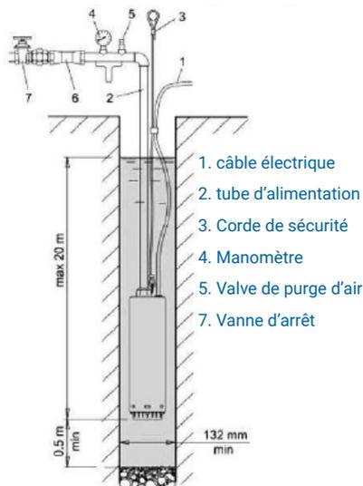
La pompe peut être maintenue en position suspendue par le tuyau d'alimentation métallique. Serrez bien les joints filetés des tuyaux pour éviter qu'ils ne se desserrent pendant le fonctionnement.
