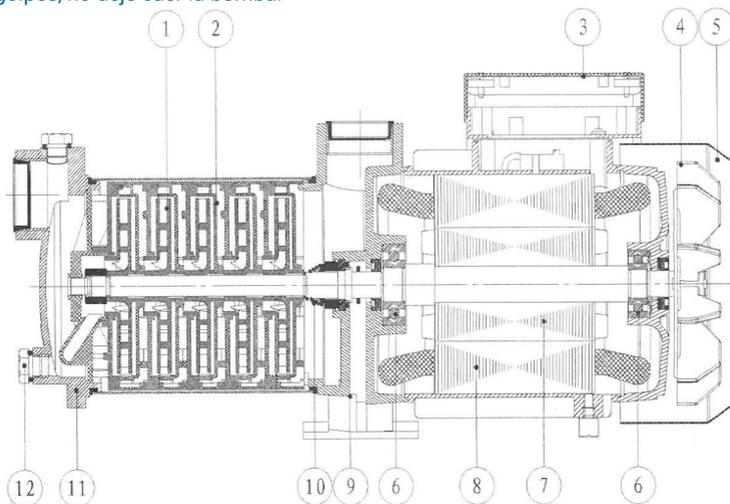
1. Impulsor 3. Caja de conexiones 5. Tapa de ventilador 7. Rotor 9. Soporte de la bomba 11. Cuerpo de aspiración 2. Difusor 4. Ventilador 6. Rodamientos 8. Bobinado del estator 10. Cierre mecánico 12. Tapón de descarga
