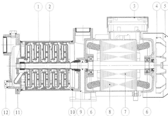
Roue 3. Boîte de jonction 5. Couvercle du ventilateur 7. Rotor 9. Boîtier d'aspiration 2. Diffuseur 8. Enroulement du stator 4. Ventilateur 6. Roulements 10. Garniture mécanique 12. Bouchon de refoulement
