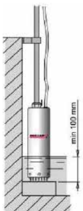
Construction sans interrupteur à flotteur
