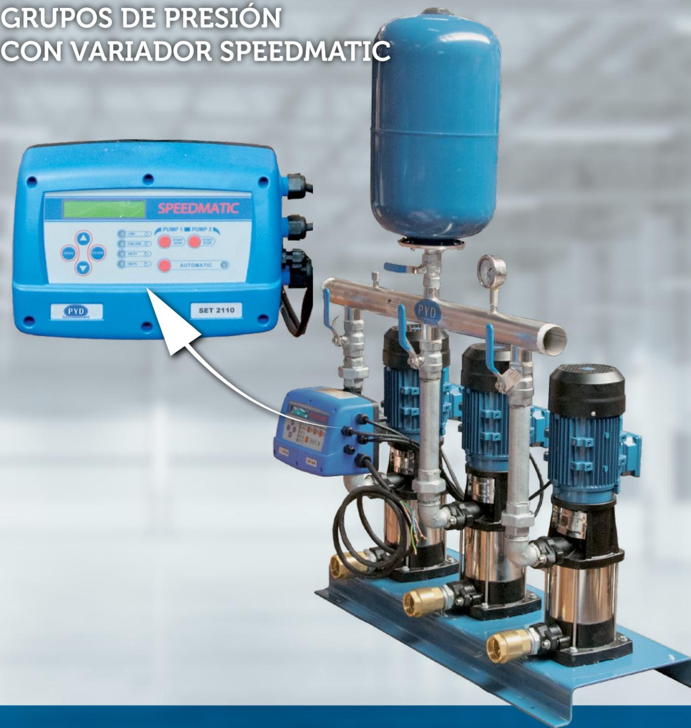
Conjuntos automáticos para el suministro de agua a presión constante, controlados por variador de velocidad mural. Se fabrican los mismos modelos indicados en las tablas de características anteriores de grupos hidroneumáticos y para prestaciones superiores. Permite la alternancia entre bombas y regulación de cada bomba en frecuencia y una gama completa de funciones de protección del motor. Estos equipos incluyen el acumulador de 25 litros y el transductor de presión.
